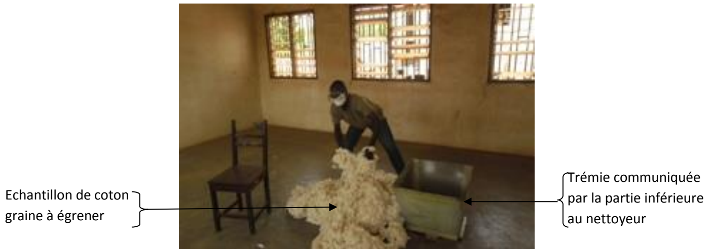
Figure 2 : Trémie située au premier étage et par laquelle l'usine est ravitaillée en coton graine.
